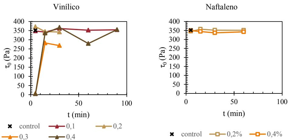
**Figura 3.** Evolución del esfuerzo de cizalla umbral para el vinílico y el naftaleno
