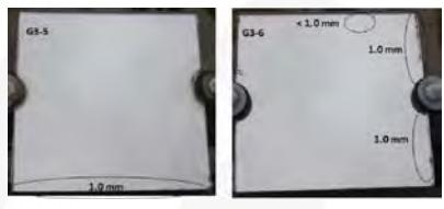
Máxima progressão da corrosão a partir das arestas **1 mm**; Corrosão fora das arestas ( $<1\text{ mm}$ ); Descamação do revestimento orgânico a partir das arestas apenas na aresta superior
